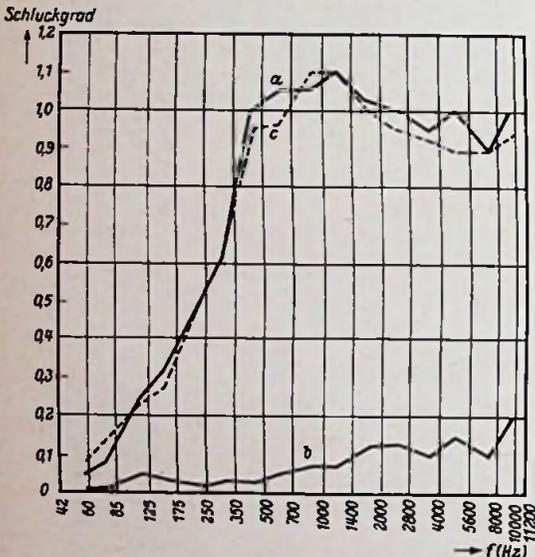
Bild 2. Messung des Schluckgrades; a = Gewebe vor 5 cm Schallschluckstoff, b = Gewebe ohne Hinterfüllung mit 5 cm Luftabstand, c = Schallschluckstoff allein
