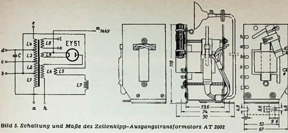
Bild 5. Schaltung und Maße des Zeilenkipp-Ausgangstransformators AT 2002
