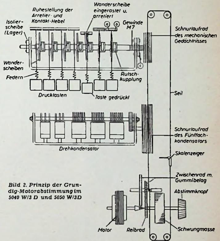
Bild 2. Prinzip der Grundig-Motorabstimmung im 5040 W/3 D und 5050 W/3 D
