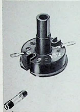
Bild 2. Das zusammengebaute Potentiometer mit einer Feinsicherung als Größenvergleich
