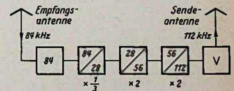
Bild 5. Vervielfacherstufen eines Tochtersenders
