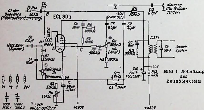
Bild 1. Schaltung des Zeitablenkteils
