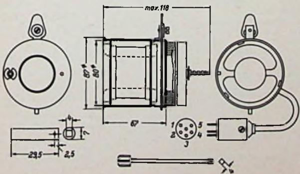
Bild 7. Ablenk- und Fokussiereinheit AT 1003
