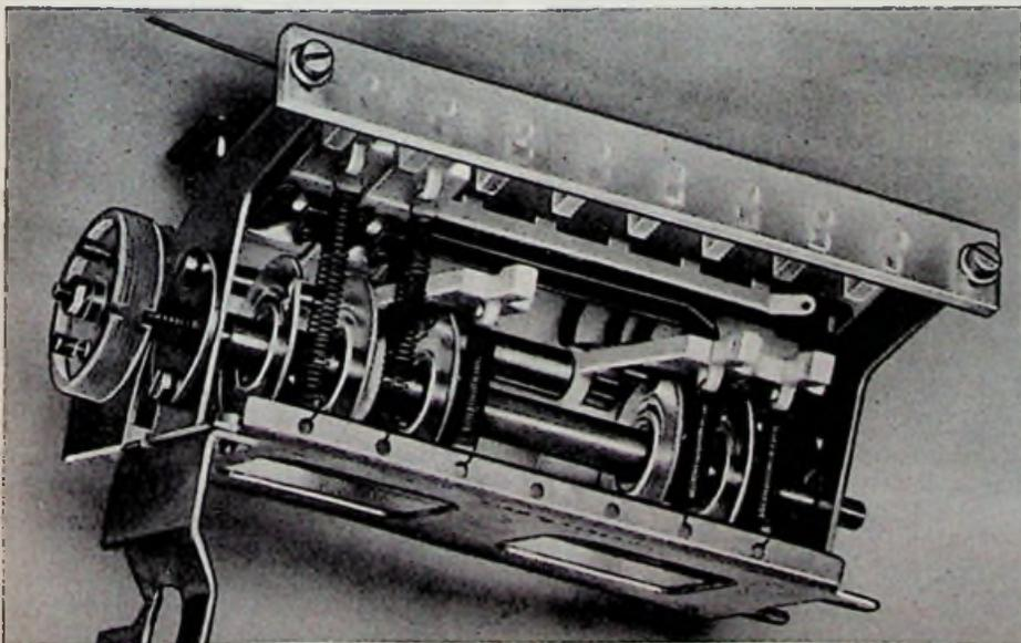
Bild 3. Das „mechanische Gedächtnis“ mit Spindel, Schnurlaufrad, fünf Wandscheiben und Arretierhebel mit Federn (Ausführung 4040 W/3 D mit fünf Scheiben)
