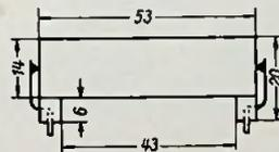
Bild 6. Batterie-Halterahmen
