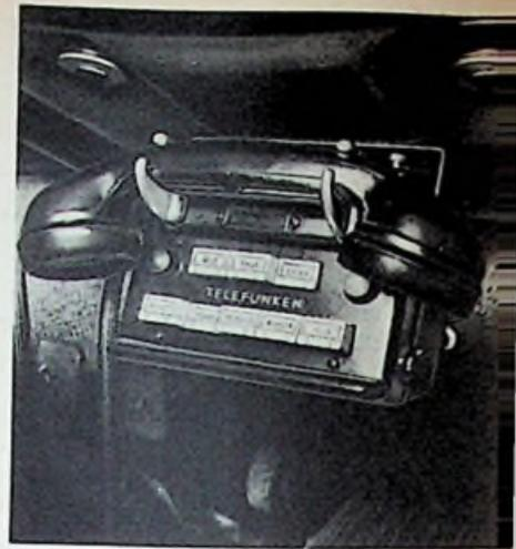
Bild 1. Der Funkfersprecher am Armaturenbrett des Volkswagens
