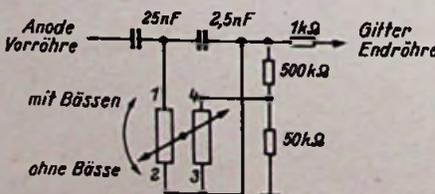
Bild 5. Praktisches Schaltungsbeispiel: Doppelpotentiometer mit einander ergänzenden Funktionen; Baßregister im Siemens-Super C 40
