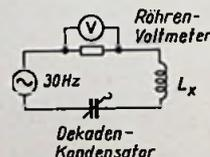
Bild 3. Meßschaltung für die Spulen
