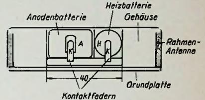
Bild 7. Schnitt durch das Gehäuse
