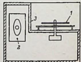
mieden werden, wenn Lautsprecher und Plattenspieler im Gehäuse so zu einander angeordnet werden, daß die Schallschwingungen in gleicher Weise von unten und von oben auf den Plattenteller auftreffen, wie das das Bild zeigt. Hier bedeuten 1 den Plattenteller und 2 den Lautsprecher, dessen Schallschwingungen sowohl von unten als auch durch die Öffnung 3 auf den Plattenteller treffen.
