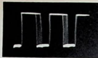
Bild 11a = Modulierte Rechteckspannung hinter der ersten Begrenzerstufe
