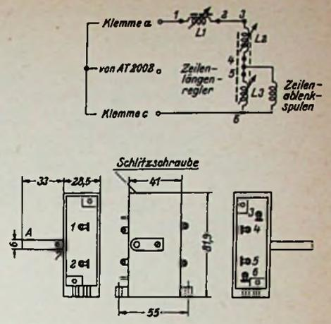
Bild 6. Schaltung und Maße des Zeilenlängen- und Linearitätsreglers AT 4001
