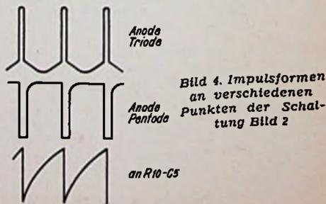
Bild 4. Impulsformen an verschiedenen Punkten der Schaltung Bild 2
