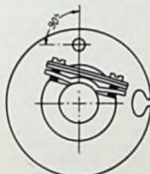
Bild 1. Wandscheibe mit Justiereinrichtung für die Rutschkupplung
