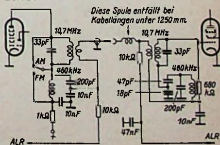
Bild 3. Zf-Kopplungsleitung zwischen den beiden Gehäusen des Philips-Autosuper ND 541 V-01
