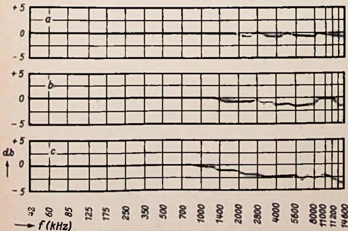
Bild 1. Schallenergieverlust von Lautsprechern bei Gewebebespannung; a = Sarangewebe Ra 13, b = Gewebe Ra 16, c = Gewebe für Außenlautsprecher
