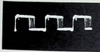
Bild 11b = Modulierte Rechteckspannung an der Anode der Röhre PL 83
