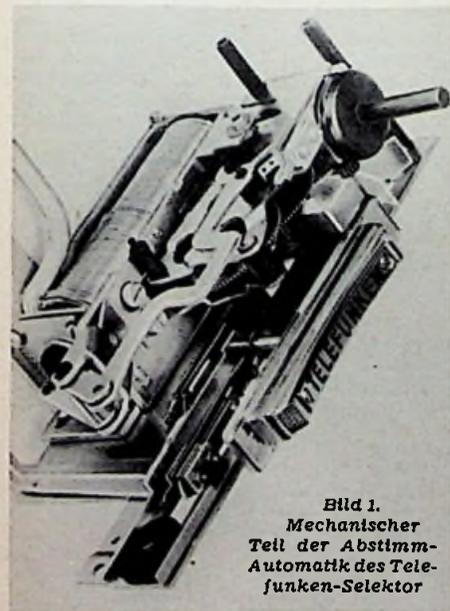
Bild 1. Mechanischer Teil der Abstimm-Automatik des Telefunken-Selektor
