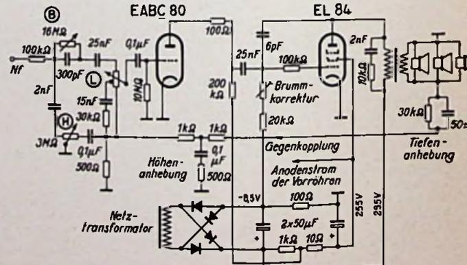
Bild 2. Nf-Teil des in die Vitrine eingebauten 6/10-Kreissupers
