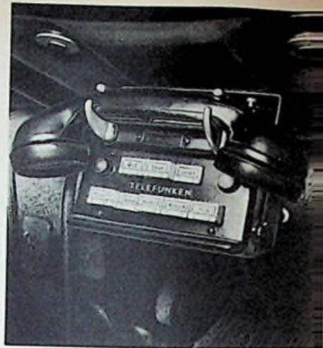
Bild 1. Der Funkfernsprecher am Armaturenbrett des Volkswagens
