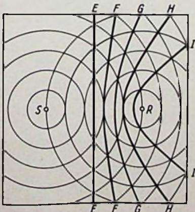
Bild 2. Die Schnittpunkte der Orte mit gleicher Phaselage lassen sich durch Hyperbeln E, F, G usw. verbinden
