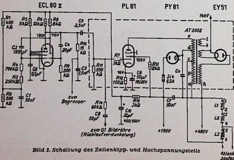
Bild 2. Schaltung des Zeilenkipps- und Hochspannungsteils
