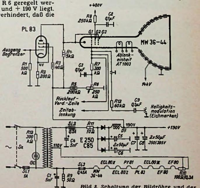
Bild 8. Schaltung der Bildröhre und der Stromversorgung
