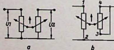
Bild 4. Verwendung als Spannungsteiler; a) mit zunehmendem Vorwiderstand auf der Sekundärseite b) mit nach den Endpunkten abnehmendem Vorwiderstand
