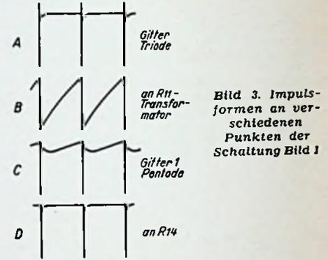
Bild 3. Impulsformen an verschiedenen Punkten der Schaltung Bild 1
