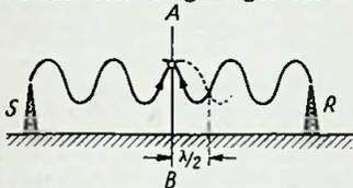
Bild 1. Von zwei Sendern ausgestrahlte Wellenzüge haben in bestimmten Abständen, z. B. an der Stelle A-B, gleiche Phaselage
